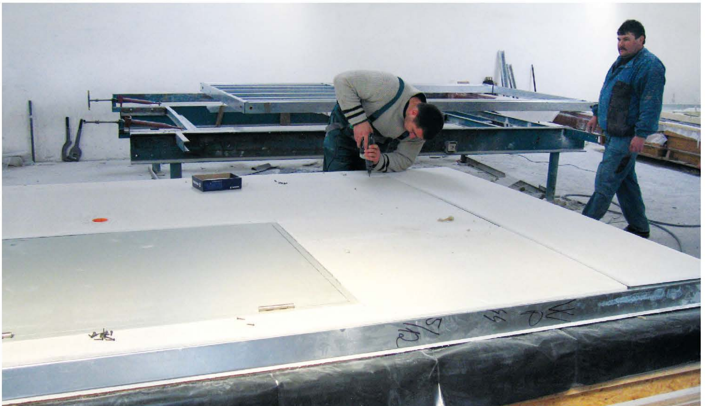
WALL PANELS ASSEMBLY | A FALPANELEK SZIGETELÉSE, KOMPLET BEFEJEZÉSE
