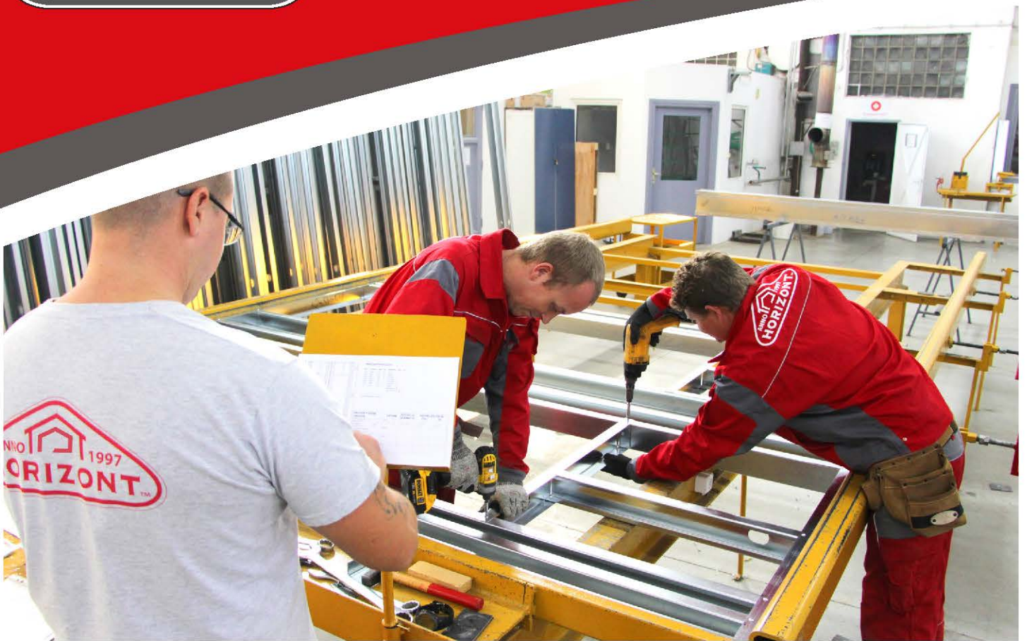
WALL PANELS PRE-ASSEMBLY | 3X4 M-ES FALPANELEK ACÉL SZERKEZETE
